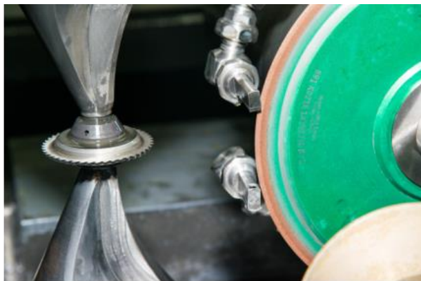
Mit einer Diamantscheibe wird den Sägeblättern der letzte Schliff gegeben.
