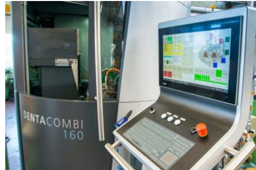
Die DentaCombi 160 ist als vollautomatische Schleifmaschine für den Mehrschichtbetrieb konzipiert.
